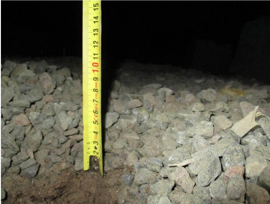
Kuva 23. Kapillaarikatkosepelin kerrosvahvuus on n. 5 cm.
