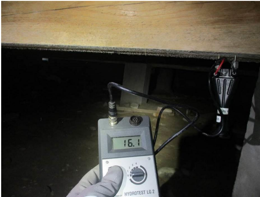
Kuva 25. Puun kosteus on vuodenaikaan nähden normaali.
