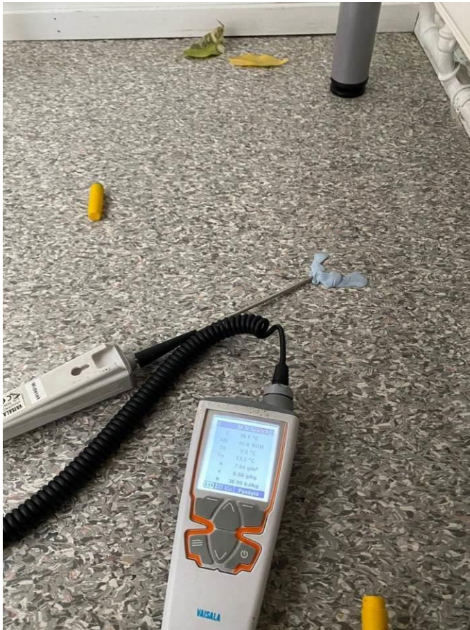
Kuva 23. Viiltomittaus, VM5 luokkatila OT3 018 ulkoseinän lähetyvillä
