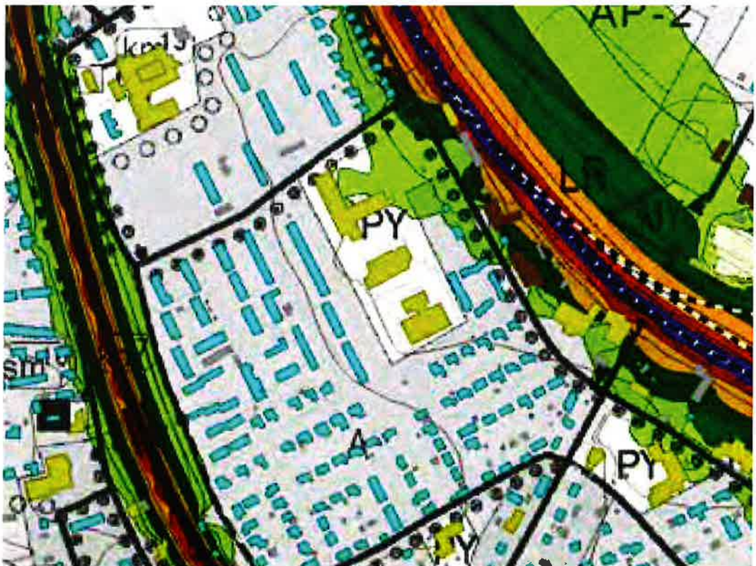
Kuva 5. Ote Haapajärven keskustan OYK meluselvityksestä (Ramboll, 2013), tie- ja raideliikenteen ennuste 2030/2040 sekä puunkuormausraide, yöajan keskiäänitaso L_{Aeq7-22} . Yöajan ohjearvo 50 dB(A) täyttyy tumman vihreästä väritäytöstä lähtien.
