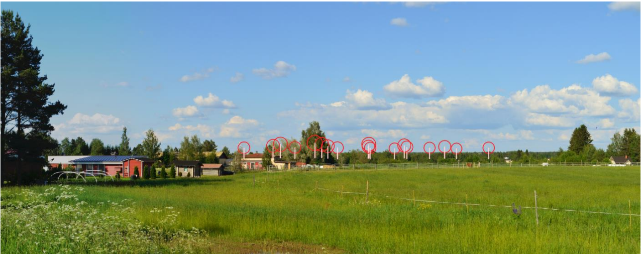
Kuva 77. Esimerkki havainnekuivasta: näkymä Haapajärven Karjalahdenrannalta Korteperän tuulivoima-alueen suuntaan. Tuulivoimalat on esitetty havainnekuivassa korostettuina symboleilla – voimaloiden tornit on esitetty valkoisilla pystyviivoilla ja pyörähdyshäät punaisilla ympyröillä. Symbolit on esitetty kuvassa näkymiä peittävän puuston päällä, joten symbolit näyttävät voimaloiden sijaintipaikat maisemassa, vaikka ne todellisuudessa jäisivät puuston taakse. Havainnekuivan pohjana on kesällä otettu valokuva, jossa maismaa peittävät puiden lehdet.
