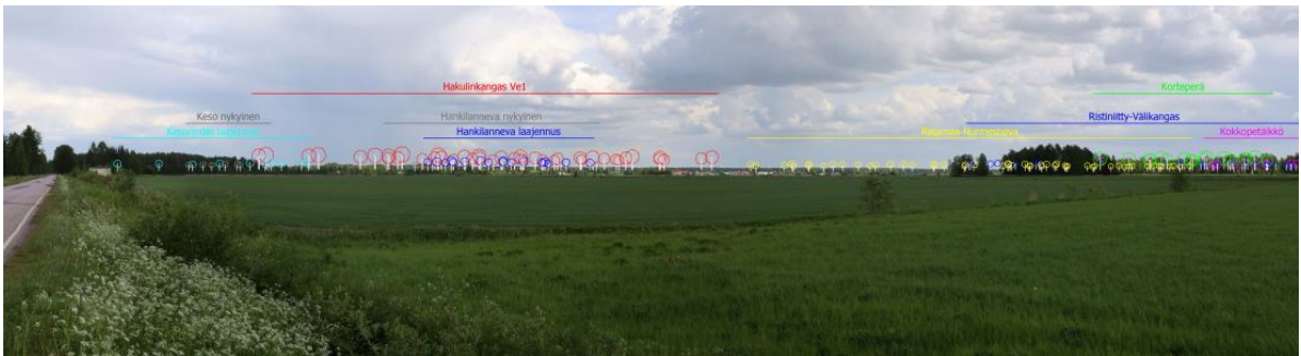
Kuva 10-22. Hakulinkankaan tuulivoimahankkeen sekä sen ympäristön tuulivoimahankkeiden yhteisvaikutuksista koottu havainnekuva noin 12 kilometrin etäisyydeltä Hakulinkankaan suunnittelualueesta lännestä (VE1, kuvapaikka N). Havainnekuvasovite on esitetty tunnisteväreillä, niin sanottuina rautalankamalleina, valokuvan päällä.
